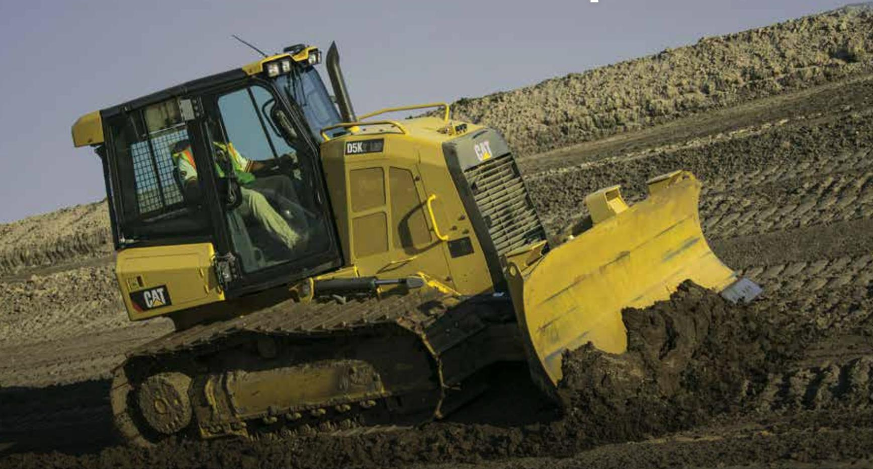
Cat Slope Assist pour tracteurs sur chaînes permet aux conducteurs d'atteindre plus rapidement le degré de pente souhaité en maintenant automatiquement des angles de lame prédéterminés pour le nivellement.
