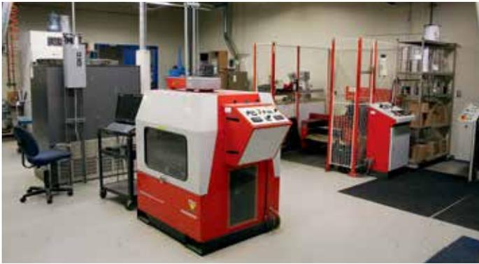
LE LABORATOIRE SUR LES CHAUSSÉES ET MATÉRIAUX BITUMINEUX (LCMB) A ÉTÉ CRÉÉ POUR RÉPONDRE AUX BESOINS DE L'INDUSTRIE EN MATIÈRE DE RECHERCHE ET DÉVELOPPEMENT SUR LES CHAUSSÉES SOUPLES ET LES MATÉRIAUX BITUMINEUX. SON ORNIÉREUR, ENTRE AUTRES, PERMET AUX CHERCHEURS DE CARACTÉRISER LA RÉSISTANCE À L'ORNIÉRAGE DES ENROBÉS DANS DES CONDITIONS COMPARABLES AUX SOLlicitATIONS SUR ROUTE.
