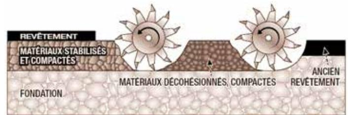
LE RETRAITEMENT DE TYPE II INTERVIENT PLUS EN PROFONDEUR, DE 100 À 300 MM, DANS LA COUCHE DE PAVAGE ET UNE PARTIE DE LA FONDATION GRANULAIRE DE LA CHAUSSÉE.
